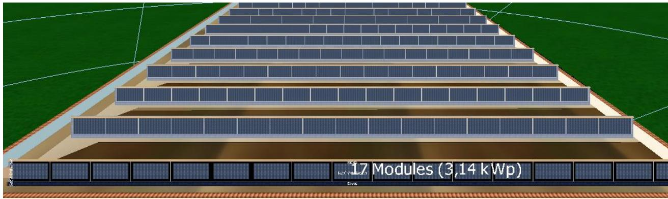
Za postavljanje elektrane od 50,320 kW<sub>p</sub> potrebna 272 FN modula nazivne snage 185 W<sub>p</sub>.
