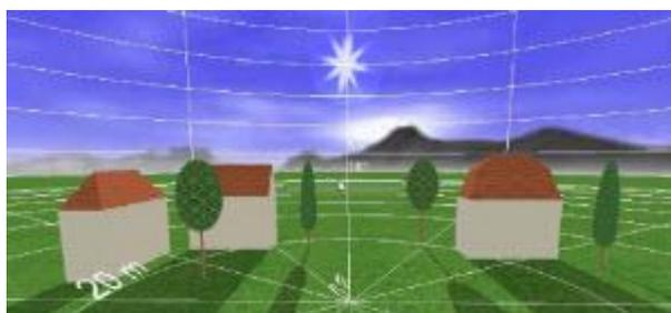
Prikazuju virtualne pozicije sunca kroz azimut i elevaciju, pomoću kutova ili pomoću vremena slijede put sunca u slobodno odabranim vremenskim razdobljima. Osim vizualnog predstavljanja, to također služi donošenju odluka, npr. koliko objekt uzrokuje sjenčanje te
