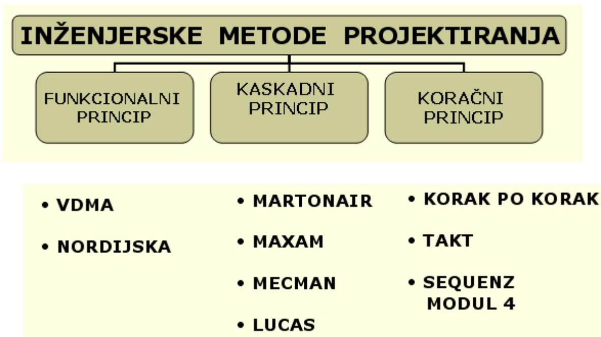
Funkcionalni principi koriste metode koje se, za otklanjanje blokirajućeg signala, oslanjaju na specifičnu funkciju rada korištenog pneumatskog elementa. To su pneumatski elementi koji, iako trajno aktivirani, na izlazu u sustav daju kratkotrajni signal, zbog specifičnog funkcioniranja mehanizma aktiviranja. Najtipičnija metoda za ovu grupu je VDMA (kratica od Verein Deutscher Maschinenbau Anstalten – Udruga njemačkih ustanova za strojogradnju).
