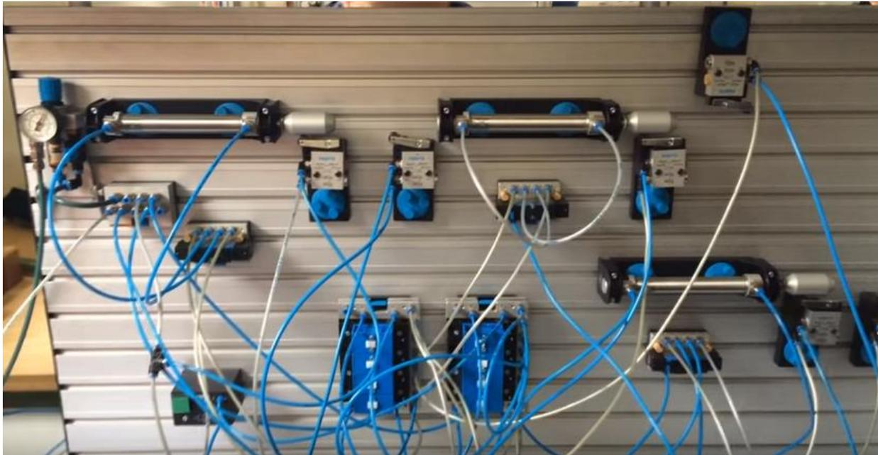
**Slika 35. Spajanje komponenti na pneumatskoj didaktičkoj ploči**
