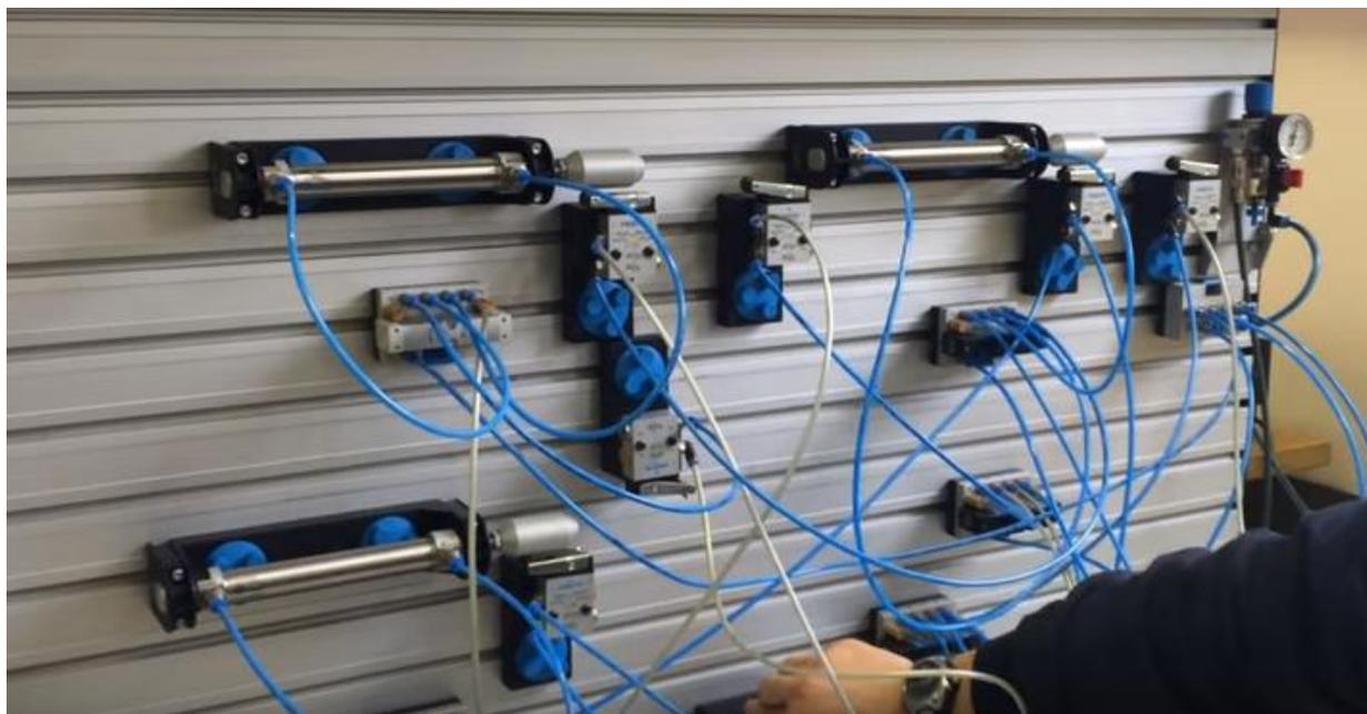
Slika 23. Spajanje komponenti na pneumatskoj didaktičkoj ploči
