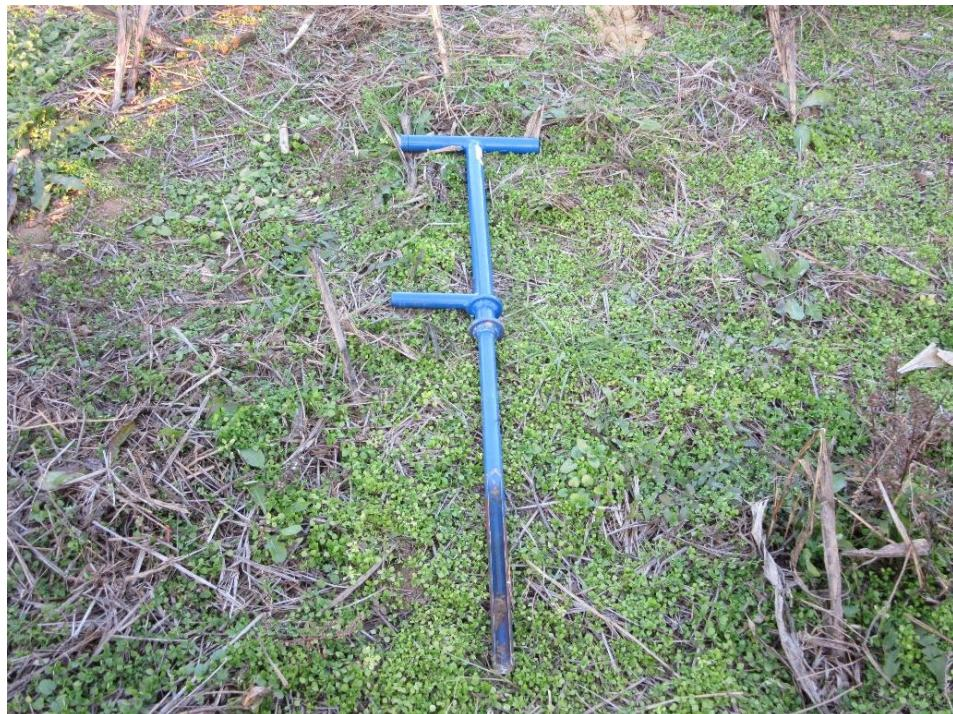
Slika 5. Sonda za uzimanje uzorka za kontrolu plodnosti
