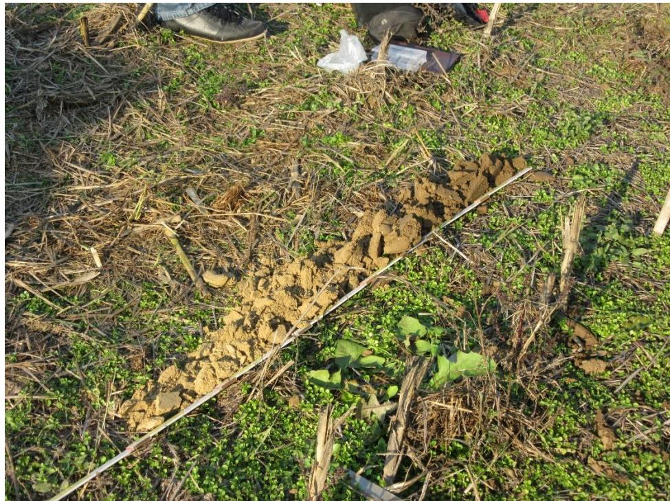
Slika 2. Prikaz sondažnog izvata
